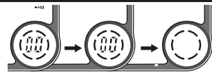
Anfütter-Timer an, Timer Alarm an Anfütter-Timer an, Timer Alarm aus Anfütter-Timer und Timer Alarm aus
