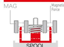
**ALL ROUND** - Permet de réduire le mouvement de l'inducteur et réduit l'action du frein à vitesse maximale. Un réglage parfait pour la majorité des conditions rencontrées.
