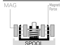
**MAX BRAKE** - Permet de disposer pleinement du frein magnétique - Très pratique lorsqu'il s'agit de lancer contre le vent ou avec des leurres qui ont une bonne prise au vent.
