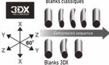
Grâce à la nouvelle fibre de carbone 3DX, la compression du blank a été considérablement améliorée. La canne dispose toujours du même transfert de puissance - quelle que soit la direction du mouvement. En outre, la canne est plus résistante à la torsion, permettant ainsi de réaliser des lancers encore plus précis.
