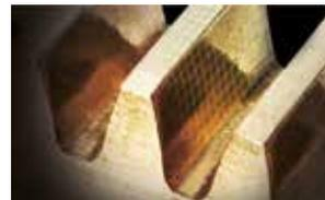
Engrenages usinés CNC qui ont été développés pour résister aux plus fortes tensions. La précision des engrenages est dix fois plus importante que sur un moulinet classique.
